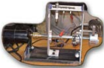
George Gravatt's magneto tester.
